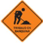
**TRABAJOS EN LA BANQUINA:** Indica que en el área se están realizando trabajos de mantenimiento en la banquina pero no afectan la vía de circulación.
