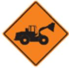
**EQUIPOS PESADOS:** Indica que en la vía hay presente equipos o maquinarias pesadas.
